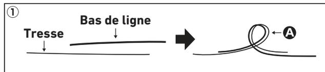
Faites une boucle A avec la tresse et le bas de ligne nylon conjointement.
