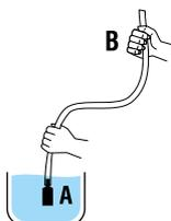
1. Placez le bout A du tuyau dans le récipient où il y a le liquide que vous souhaitez transférer et tenez le bout B du tuyau en position verticale.
